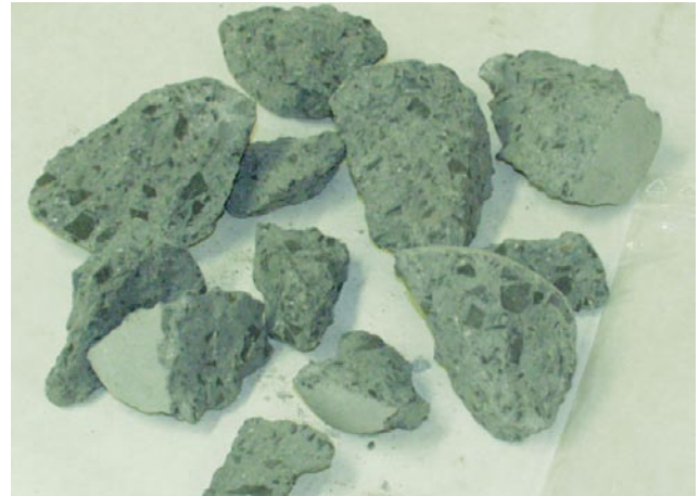
8 Gegenüberstellung der Zerkleinerungsprodukte aus Leichtbeton (a) und hochfestem Beton (b) Comparison of the comminution products of lightweight concrete (a) and high-strength concrete (b)
